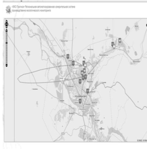
Рис. 3. Результат моделирования концентраций от оцененных источников в информационной системе мониторинга города Усть-Каменогорска
