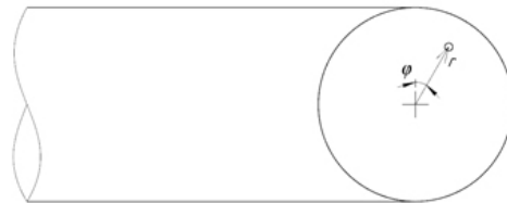
Рис. 7. Расположение полярной системы координат \{r, \varphi\} в сечении измерения
